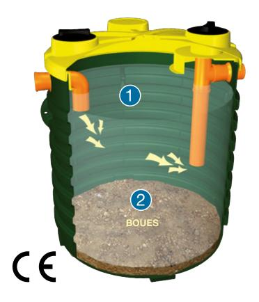
ZONE DE TRANQUILLISATION Zone où l'effluent en entrée ralentit en permettant la décantation des boues et la séparation des substances légères éventuelles.
